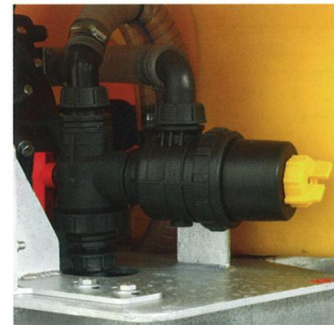
filtre d'aspiration avec vanne de rinçage
